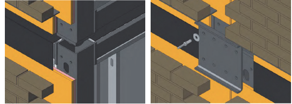
(a) Connecting using blind rivets (Kullman Building Corp.)
