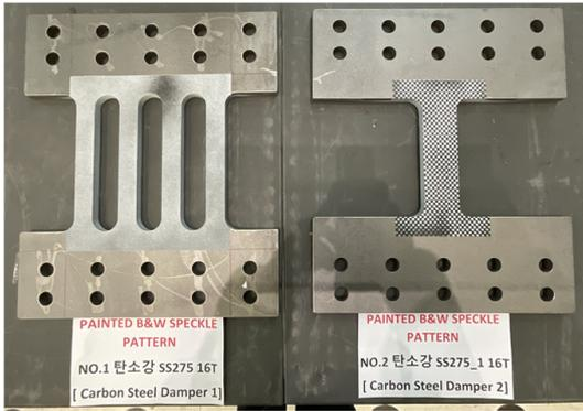
Fig. 17. Hybrid Carbon Damper(CD+CD\_1.0)
